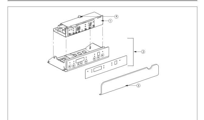
Fig. 33: CHALLENGER Control Components
