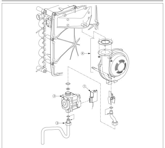
Fig. 31 : CHALLENGER Blower & Gas Valve Components
